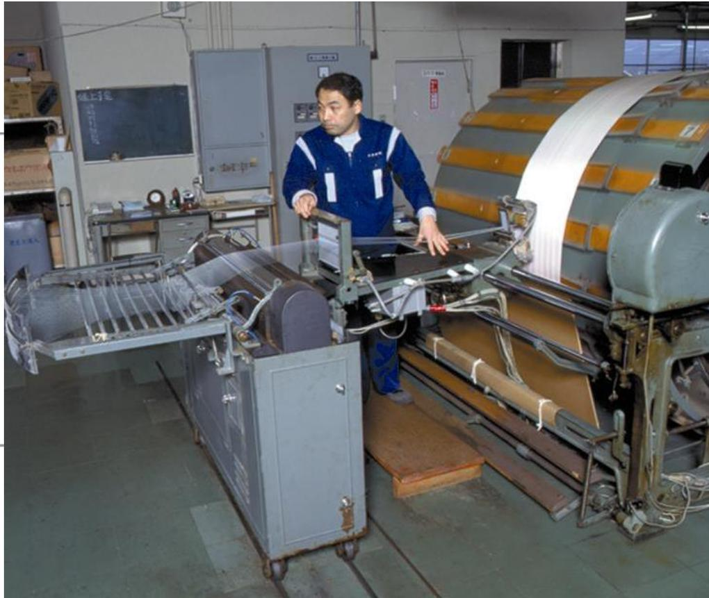
経糸を織機に仕掛けるための準備。ボビン枠に巻かれた120～200本の糸を一度にドラムに巻き取り、さらに男巻というビームに30～50反分を巻き上げます。
