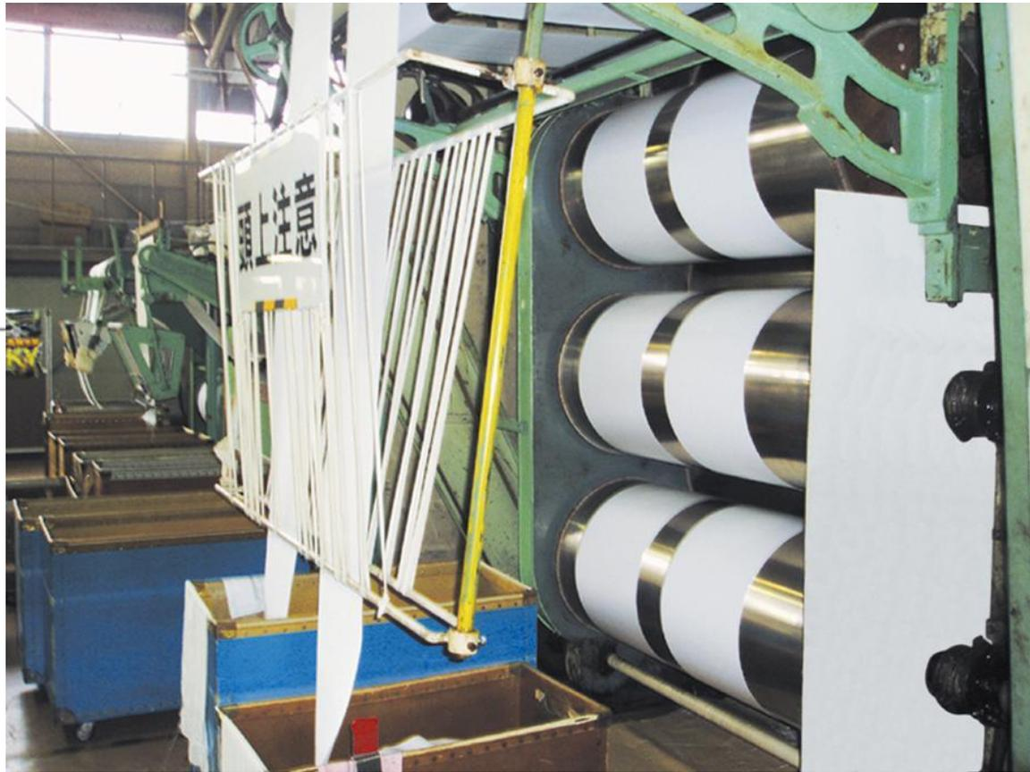
精練が済んだちりめんを水洗、脱水し、乾燥機にかけます。乾燥方法によってシボや風合いに大きな違いが出るため、ちりめんの種類に応じた最適の方法が採られます。
