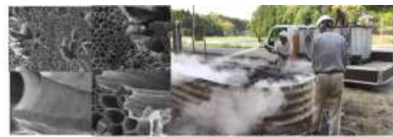
P炭の主な特徴 ①水を自重の2倍まで吸い上げ ②保水性が高い ③強い吸着力が高い ④遠赤外線機能を有する K-BETS開発DECA2使用による Porus竹炭製造現場
